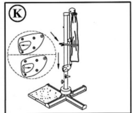
**Pour refermer la toile toujours tourner la manivelle dans le sens inverse des aiguilles d'une montre**
