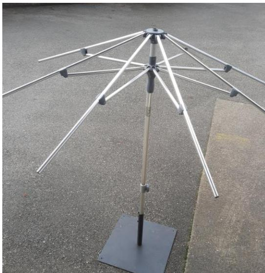
4. **Placer la nouvelle toile sur la structure en alignant les diagonales de la toile et des baleines.**
